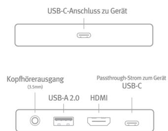
Hinweis: Wenn sowohl HDMI als auch 3,5 mm angeschlossen sind, wird der Ton über den 3,5 mm Anschluss ausgegeben. Wenn das StayGo mini bereits mit dem Gerät verbunden ist, kommt der Ton von dem Anschluss, der zuletzt verbunden war.
