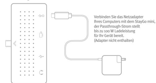
Verbinden Sie das StayGo mini direkt mit Ihrem Gerät oder verwenden Sie das mitgelieferte Kabel (0,5 m).
