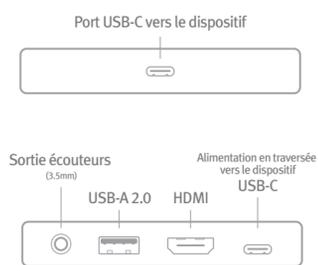
Remarque : si HDMI et 3,5 mm sont connectés, le matériel audio proviendra du port de 3,5 mm. Si StayGo mini est déjà connecté au dispositif, le matériel audio proviendra du dernier port connecté.
