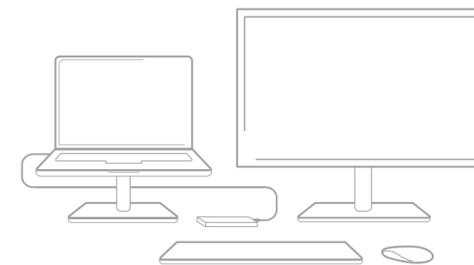
Reisemodus: Ziehen Sie das Reisekabel aus dem Kabeleinschub an der Seite des StayGo, schließen Sie das Kabel an den USB-C-Anschluss an der Seite des StayGo an und verbinden Sie das andere Ende mit Ihrem Gerät.
