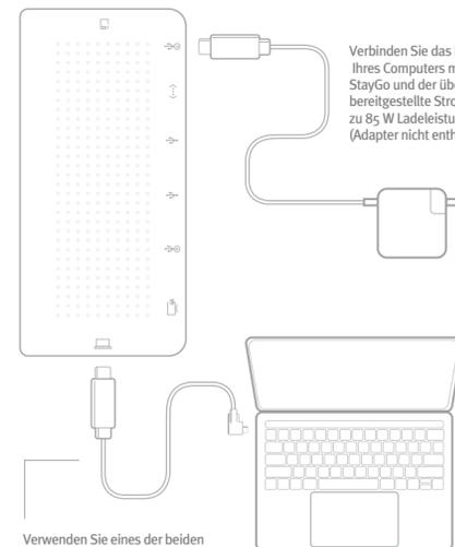
Verbinden Sie das Netzteil Ihres Computers mit dem StayGo und der über Passthrough bereitgestellte Strom liefert bis zu 85 W Ladeleistung für Ihr Gerät. (Adapter nicht enthalten)
