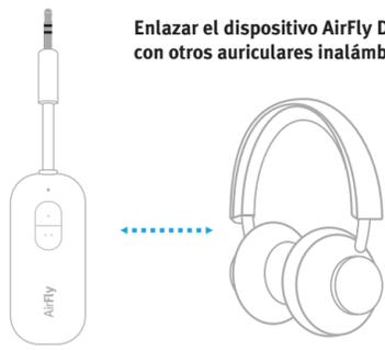
1 Para activar el modo de enlace, encienda su AirFly Duo. Una vez encendido, el LED del AirFly parpadeará en blanco y en ámbar para indicar que está listo para enlazarse con sus auriculares. Si el LED no parpadea una vez encendido el dispositivo, mantenga pulsado el botón 1 durante cuatro segundos para activar el modo de enlace.
