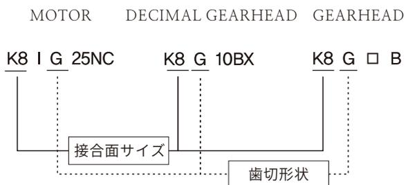
※ ギヤヘッド単品では得られない大きい減速比が必要な場合にはDECIMALギヤヘッドを使ってギヤヘッド単品より回転数は1/10に減りますが減速機側で許容トルクが定めているのでDECIMALギヤヘッドを使っても許容トルクは増加しません。
