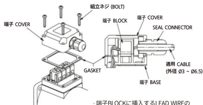
・端子BLOCKに挿入するLEAD WIREの脱皮の長さは5~8mmにしてください。
