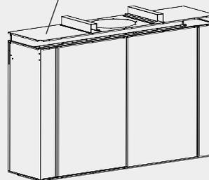
Le pareti posteriori e i due pannelli laterali sono inseriti in una **Base con guida esterna sagomata** che, in pratica, trasforma l'intera struttura in un corpo unico.
