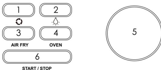
1. **Rotation** : À utiliser avec le tournebroche. Appuyez sur le bouton de rotation pour activer le mode rôtisserie et faire tourner l'accessoire pour obtenir un résultat croustillant. Appuyez de nouveau pour désactiver la fonction de rôtisserie. La fonction de rôtissoire peut être activée/désactivée à n'importe quel moment pendant la cuisson. Le bouton de rotation et l'icône s'allumeront quand il est activé.
