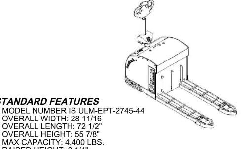
LOWERED HEIGHT: 3 1/2" GROUND CLEARANCE UNDER THE FORKS: 1 1/8"
