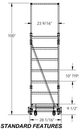
MODEL NUMBER IS LAD-PW-26-7-G OVERALL WIDTH IS 28 1/16" USABLE WIDTH IS 23 9/16" **OVERALL LENGTH IS 56 5/16" USABLE LENGTH IS 51 1/2" OVERALL HEIGHT IS 100"** PLATFORM HEIGHT IS 70" STEP TYPE IS GRIP STRUT CLIMB ANGLE IS 58° STEP DEPTH IS 7" PLATFORM DEPTH IS 14" **COLOR IS VESTIL BLUE BOTTOM STEP COLOR IS YELLOW** MAX CAPACITY IS 350 LBS FRONT WHEEL IS SWIVEL, SIZE IS Ø 3" REAR WHEEL IS RIGID, SIZE IS Ø 4"
