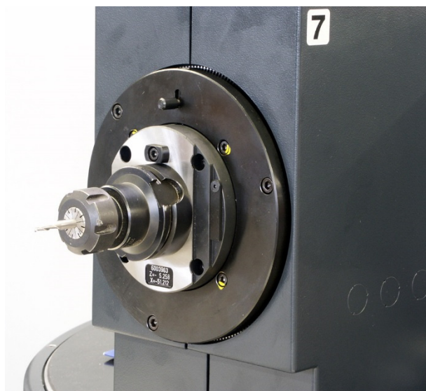
Fig. 17 : Assemblage de la fixation d'outil HGV-ZU (grandeur 1)
