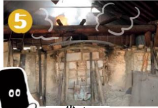
5 炭化 窯を閉じて、空気の量を 調整していきます。
