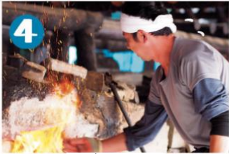
4 火入れ 窯の手前側でナラの 端材に火を付けます。
