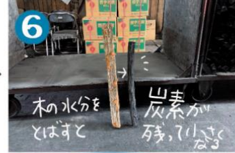
6 取り出し 水分や不純物が抜け、 ぎゅっと詰まって小さくなりました。
