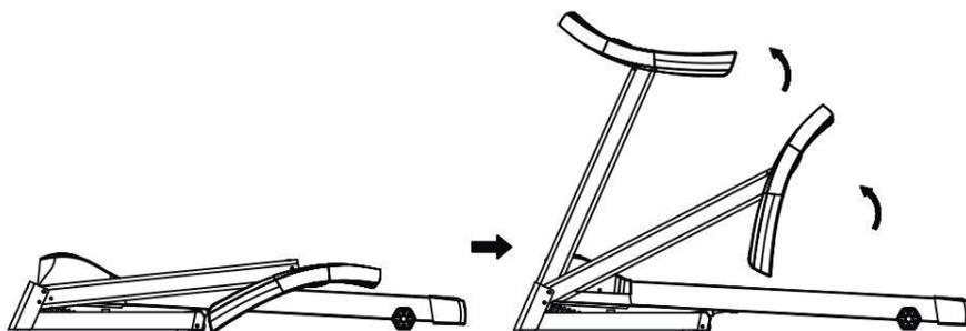
Paso 2. Utilice una llave hexagonal del #5 y un tornillo M8 \* 42 para bloquear la base y luego fije la columna a la base con tornillo M8 \* 22.
