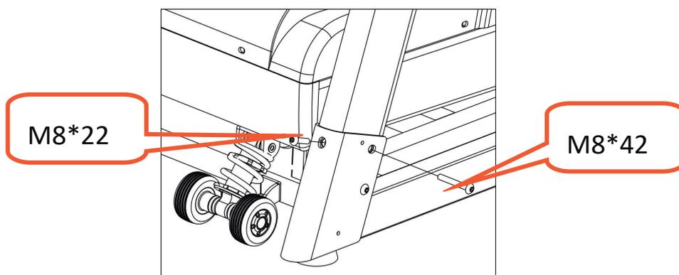
Paso 3. Sostenga las columnas izquierda y derecha, use una llave hexagonal interna #6 para bloquear el marco de la consola en las columnas con tornillo M8 \* 25.
