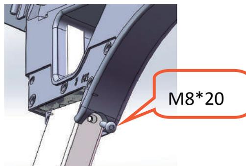
4. Después de bloquear la consola, coloque las cubiertas decorativas de las manijas a ambos lados de la posición correspondiente de las asas.
