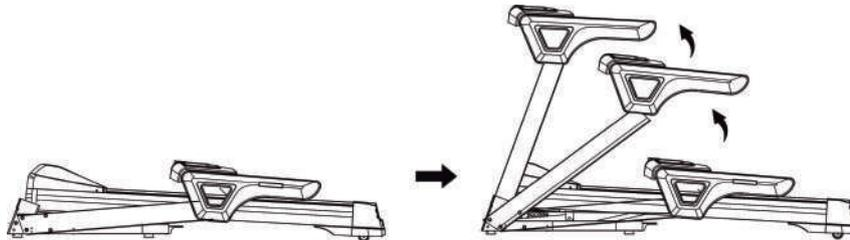
2. Utilice una llave hexagonal interior #5, un tornillo M10 \* 50 mm, un tornillo M8 \* 20 y una tuerca M8 para bloquear las columnas en la base, como se muestra en la siguiente imagen:
