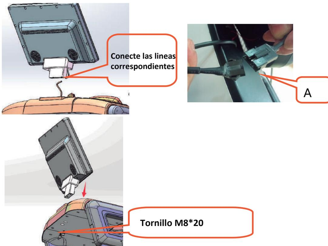
6. Saque la consola, conecte las líneas de señal una por una (A), coloque las líneas extra expuestas en la carcasa y luego coloque la consola en la ranura de la consola (tenga cuidado y no se atasque o corte las líneas), ajuste la posición y use el tornillo M8 \* 20 para bloquearlo firmemente.
