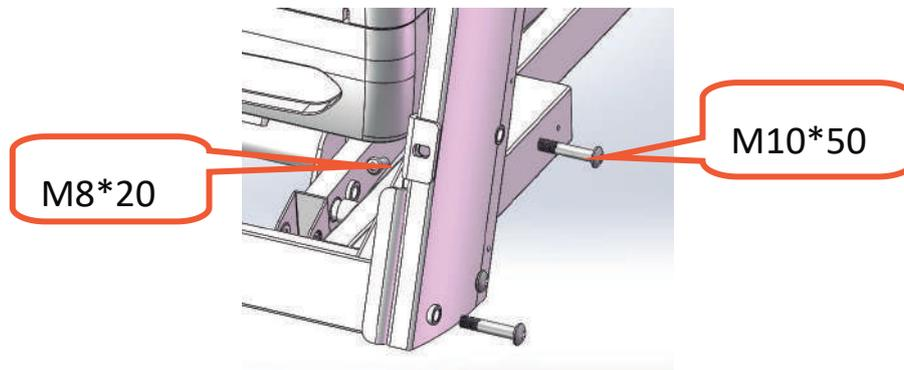
3. Despliegue la consola de visualización y use el tornillo M8 \* 20 para bloquear la consola en la posición vertical columnas.
