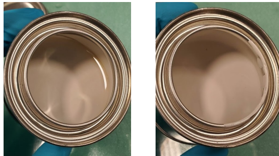
Figure 1: Left - Unmixed Primer Part A, Right - Properly mixed Primer Part A.
