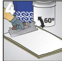
Coloque el adhesivo en la parte posterior de la loseta utilizando la parte plana de la llana sosteniéndola en un ángulo de 60° de la superficie.
