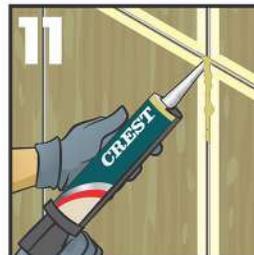
En instalaciones que estén sometidas a micromovimientos estructurales, choques térmicos o vibraciones es recomendable el uso de sistemas de juntas flexibles como CREST Flexigrout® y Crest Boquifom®.
