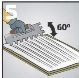
Posteriormente con la sección dentada de la llana inclinada a 60° haga surcos en forma lineal.
