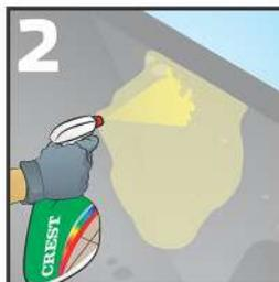
2 Posteriormente usar un limpiador ácido (Crest Clean Obra) para neutralizar el limpiador alcalino y abrir poro de la loseta cerámica.
