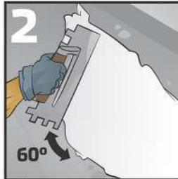
Aplique una capa de adhesivo sobre el sustrato utilizando la parte lisa (plana) de la llana sosteniéndola en un ángulo de 60° de la superficie.
