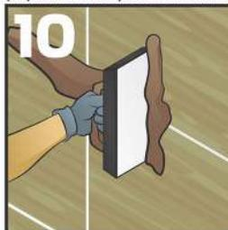
Para juntas menores a 3 mm. utilizar JuntaCrest Ultramax®, juntaedor sin arena sílica y para juntas mayores a 3 mm. Utilizar BoquiCrest Ultramax®, emboquillador con arena sílica.
