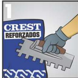
Utilice una llana dentada de tamaño apropiado, dependiendo del formato de la loseta a instalar.
