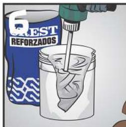
6 Revuelva bien hasta formar una mezcla homogénea. Deje reposar la mezcla 5 minutos. Para lograr una mezcla homogénea se recomienda un mezclador eléctrico de bajas revoluciones.
