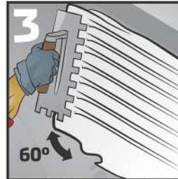
Inclinando la llana con la sección dentada en un ángulo de 60° de la superficie, haga surcos o cordones en forma lineal sobre el adhesivo recién aplicado.
