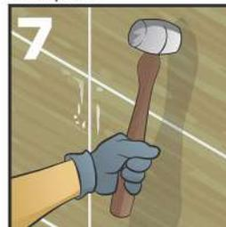
Golpear las losetas con un mazo de hule levemente del centro de la loseta hacia afuera para sacar el aire y asegurar su contacto con el adhesivo.
