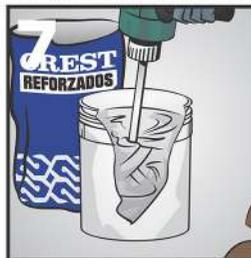
7 Revuelva bien hasta formar una mezcla homogénea. Deje reposar la mezcla 5 minutos. Para lograr una mezcla homogénea se recomienda un mezclador eléctrico de bajas revoluciones.
