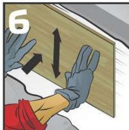
Coloque la loseta con los cordones paralelos a los cordones del sustrato procurando moverlas ligeramente hacia arriba y abajo en sentido perpendicular al rayado del adhesivo.
