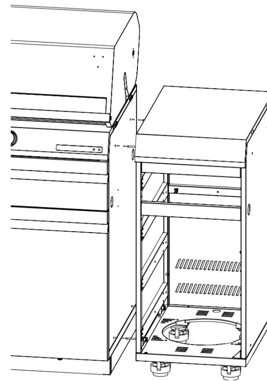
! Die Schrauben werden eventuell nicht direkt auf der gleichen Höhe sein, wie die Verbindungslöcher des nebenstehenden Moduls. Schiebe die Module so nah zusammen, wie möglich, bevor Du sie in der Höhe ausrichtest.
