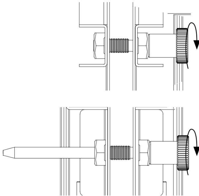
! Drehe die Schrauben erst handfest an, bevor Du sie mit dem Sechskantschlüssel festziehst.
