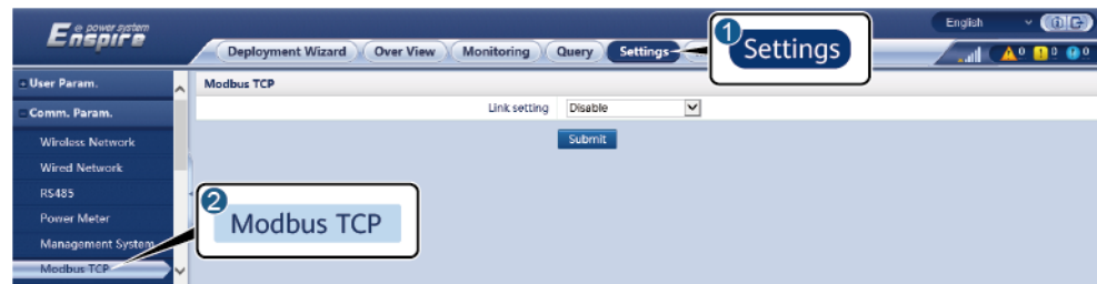
Figure 6-36 Setting Modbus TCP parameters
