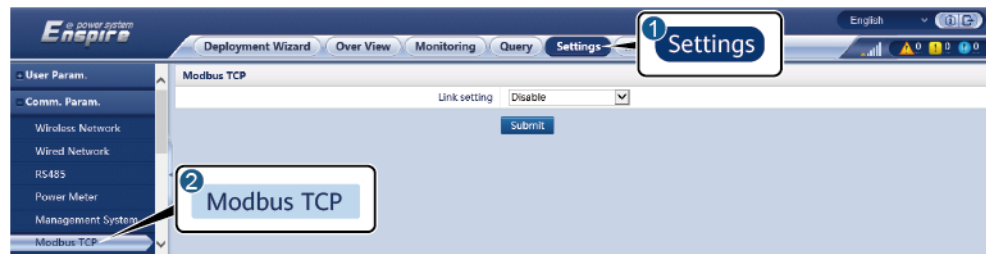
Figure 6-32 Setting Modbus TCP parameters
