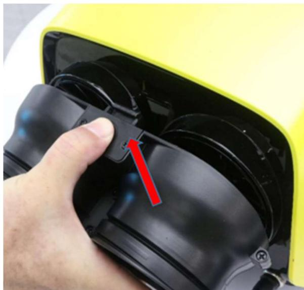
②再拔下端扣位处，即可拆卸完成；
