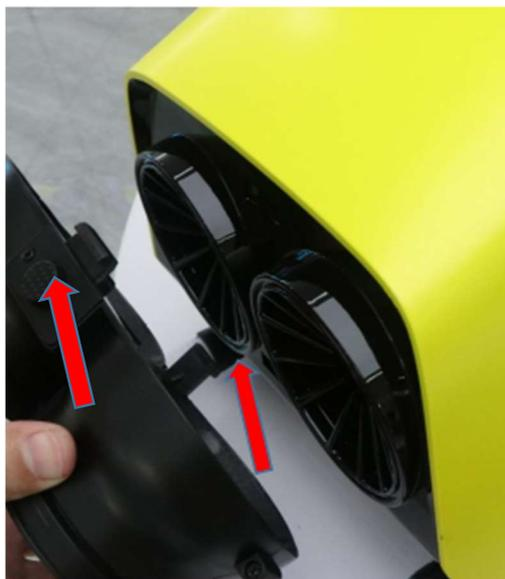
③ 按住按键，同时将连接器上端扣位插入对应后板孔位
