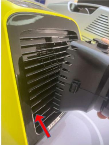
③按住按键，同时将前连接器上端扣位插入前板孔位；
