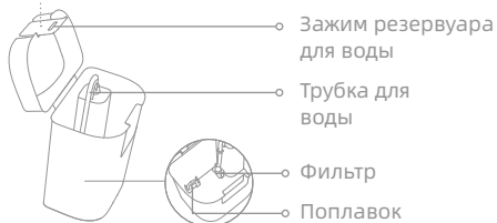
Резервуар для чистой воды
