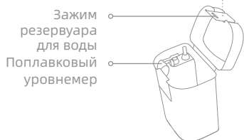
Резервуар для использованной воды
