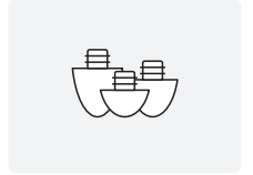
قدم قابلة للانعكاس لتعديل زاوية جهاز ساونديار
