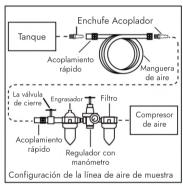
4. Conecte una válvula reguladora, una válvula de cierre en línea y una manguera de aire de 1/4" NPT al acoplamiento rápido (76) (todo ello se vende por separado). La manguera de aire debe ser lo suficientemente larga como para llegar a la zona de trabajo con una longitud extra suficiente para permitir el movimiento libre mientras se trabaja.
