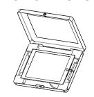
7B. INSERT TABLET AS SHOWN. MAKE SURE TO PLUG IN POWER CABLE TO TABLET AND CABLE ROUTE THROUGH THE BACK.
