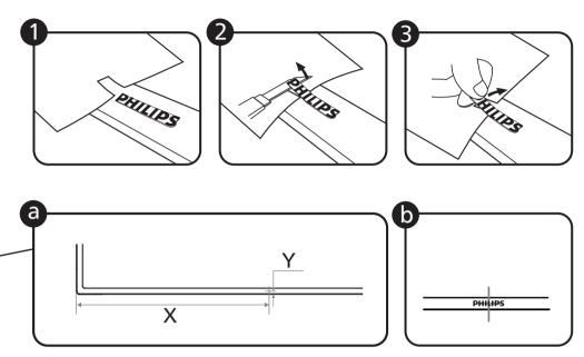
43BDL3650Q: X=280.6 mm Y=7.4 mm 50BDL3650Q: X=324.5 mm Y=7.9 mm 55BDL3650Q: X=356.3 mm Y=7.4 mm
