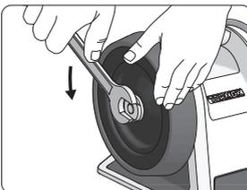
Abziehscheibe lösen, indem die Komposit-Abziehscheibe mit einer Hand festgehalten wird und die Mutter der Abziehscheibe mit einem 19-mm-Schlüssel gelöst wird. Die gesamte Achse herausnehmen.
