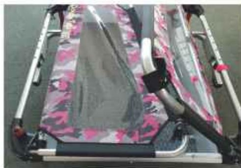
Klappen Sie die Seitenteile des Doggy-Tourer hoch. Drehen Sie die linke Heckstangenhalterung so nach innen, dass sich der Schnellspanner links vom Seitenrohr befindet und die Halterung für die Heckstange nach innen zeigt. Schließen Sie den Hebel des Schnellspanners. Der Hebel soll nach hinten zeigen, damit er nicht beim Streifen an Hindernissen geöffnet werden kann.
