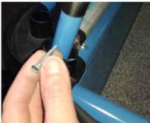
Bohren Sie mit einem 2,5er-Bohrer ein Loch, wie auf der Abbildung zu sehen, und schrauben Sie die mitgelieferten Schrauben mit einem Inbus bis zum Anschlag an.
