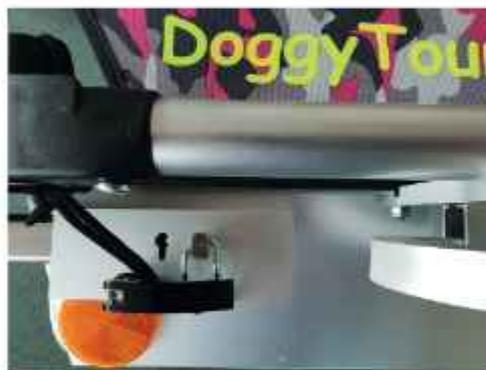
Schieben Sie den Sicherheitssplint in die Öffnung und legen Sie den Hebel des Sicherheitssplints um. Drehen Sie den Schnellspanner fest. Halten Sie dafür mit der linken Hand die Mutter auf der linken Seite der Deichselaufnahme fest und drehen Sie mit der rechten Hand den Schnellspannhebel fest. Drehen Sie so lange fest, bis sich der Hebel nur noch mit viel Kraftaufwand umlegen lässt.
