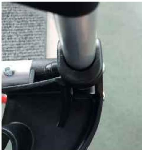
Stecken Sie die mitgelieferten Schrauben M6 x 40 in die dafür vorgesehenen Löcher. Unter Mithilfe eines flachen Schraubendrehers lässt sich das Seitenteil (Abbildungen unten) leichter anheben, bis es passgenau sitzt.
