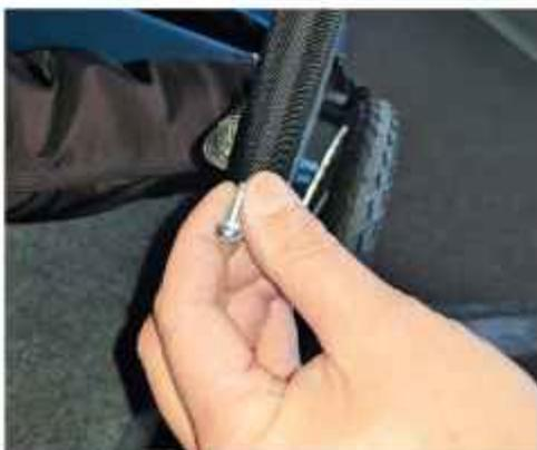
Im hinteren Teil müssen Sie, wie auf dem Bild vorgegeben, durch den Stoff bohren. Hier verwenden Sie wieder den 5er-Bohrer.
