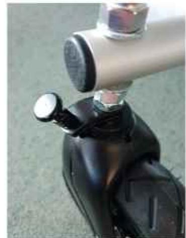
Das Buggyrad kann anhand des schwarzen Schnäppers oberhalb des Buggyrades in zwei Positionen gestellt werden: beweglich (bester Fahrkomfort) und fest (zum Verstauen des Rades). Zum Verstellen ziehen Sie am schwarzen Zugschnäpper an der Lenkgabel des Buggyrades. Verdrehen Sie den Zugschnäpper etwas. Jetzt ist das Buggyrad beweglich.
