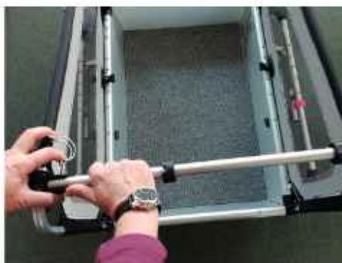
Ziehen Sie den rechten schwarzen Ring, soweit es geht nach außen, bis über den Druckknopf und über die schwarze Heckstangenhalterung. Am besten Sie stehen auf der rechten Seite und ziehen den schwarzen Ring zu sich. Die Druckknöpfe müssen auf jeder Seite herauspringen, damit die Heckstange gesichert ist.
