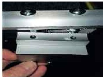
Falls Sie das Buggy- oder Joggerad nachrüsten möchten, ist die Profil-Aufnahme für das Rad mit 2 Schrauben anzubringen. Die Aufnahme für das Rad wird am umlaufenden Rahmen, vorne links vor der Wanne befestigt (gesehen, wenn Sie hinter dem Anhänger stehen).
