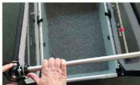
Stecken Sie jetzt den Sicherheitsstift in die dafür vorgesehene Bohrung an der Heckstange und legen Sie den Hebel des Stiftes um. Ziehen Sie das Seitenteil um ca. 1,5 mm nach außen! Um eine Verletzungsgefahr zu vermeiden, achten Sie bitte darauf, den Splint von vorne nach hinten in die Heckstange zu schieben, so dass der Stift nach hinten zeigt.
