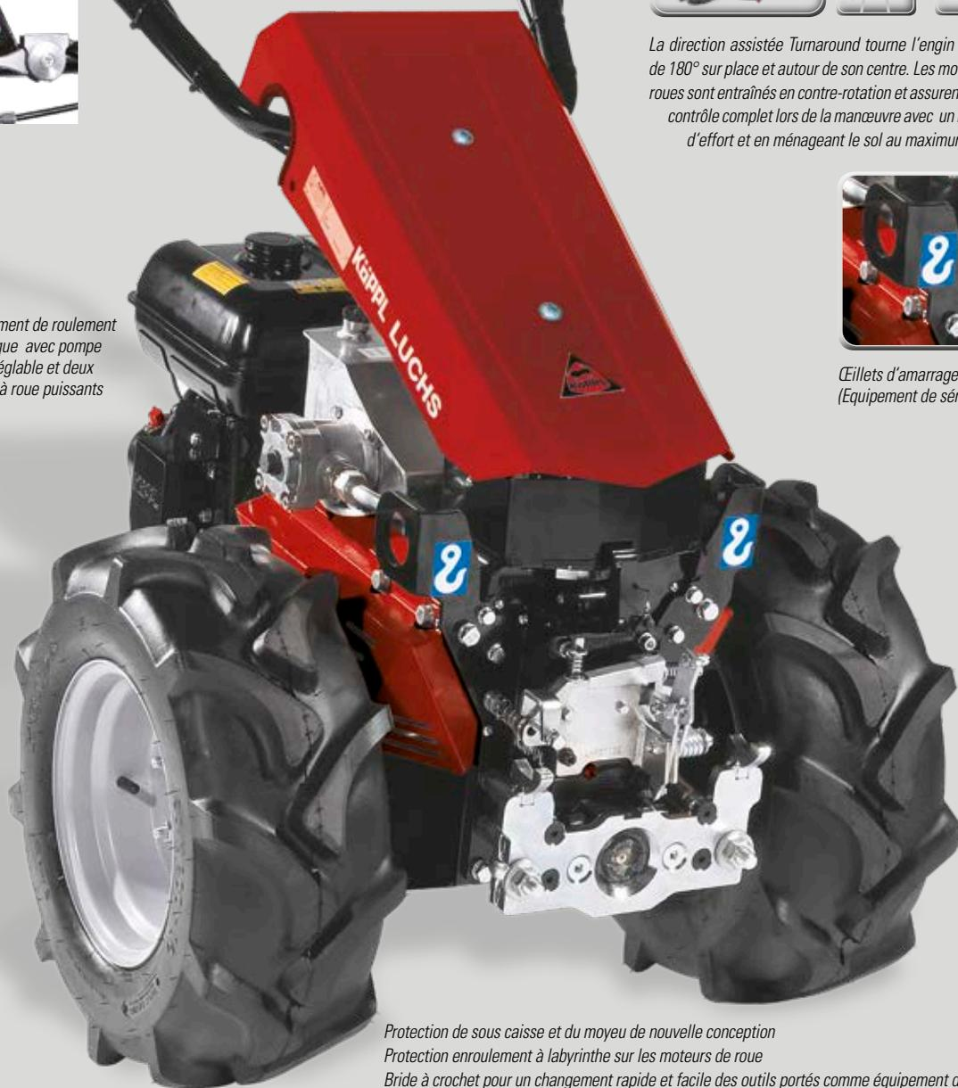
Protection de sous caisse et du moyeu de nouvelle conception
