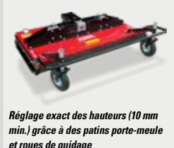
Réglage exact des hauteurs (10 mm min.) grâce à des patins porte-meule et roues de guidage
