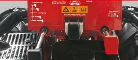
Tableau de bord clair avec réglage de la hauteur du guidon et affichage du schéma des vitesses
