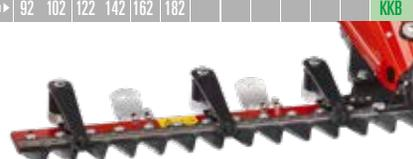
Dos de lame 8 mm barre communale. Bouton presseur à ressort réglable et lubrifiable. Lames doubles vissées. Lames doubles Köppel Korodur® 3,6 mm → longue tenue de coupe → pour situations extrêmes. Talon du sep de biotope en tant qu'accessoire
