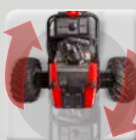
La direction assistée Turnaround tourne l'engin motorisé de 180° sur place et autour de son centre. Les moteurs des roues sont entraînés en contre-rotation et assurent ainsi un contrôle complet lors de la manœuvre avec un minimum d'effort et en ménageant le sol au maximum.
