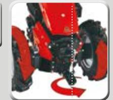
La direction assistée Turnaround tourne l'engin motorisé de 180° sur place et autour de son centre. Les moteurs des roues sont entraînés en contre-rotation et assurent ainsi un contrôle complet lors de la manœuvre avec un minimum d'effort et en ménageant le sol au maximum.
