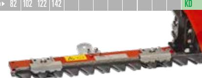
Double porte-lame avec dos de lame 8 mm et plaque de guidage réglable. Support de barre et plaque de guidage des lames en fonte spéciale. Lames doubles Köppel Korodur® 3,6 mm. Lame de coupe posée sur toute la surface et coudée vers l'arrière → bonne conduite permanente de la lame → bon rejet de l'herbe, aussi en pente
