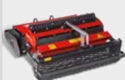
Embrayage à glissement comme sécurité de surcharge et entraînement latéral à chaîne pour un résultat homogène
