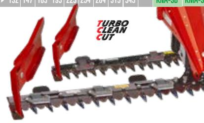
Barres de coupe à doigts normale (KNA) et moyenne (KMA) avec dos de lame en acier à ressort 6 mm et lames de 2mm, doigts forgés avec un écart de 50,8 mm (KMA) ou 76,2 mm (KNA). → longue tenue de coupe, fauchage rapide pour des tâches difficiles conforme à DIN 80. Avec un ajout de coupe extérieur sur les deux côtés, contre-seps (coupe haute) et tôles à andains → barre de coupe haute (moins de bouchages à haute vitesse de fauchage)
