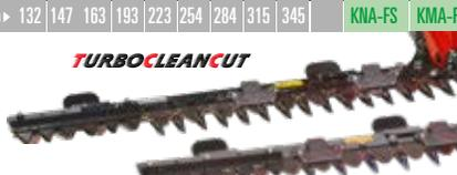
Barres de coupe libre normale (KNA) et moyenne (KMA) avec dos de lame en acier à ressort 6 mm et lames de 2mm, doigts forgés avec un écart de 50,8 mm (KMA) ou 76,2 mm (KNA). → longue tenue de coupe → pour des tâches de fauchage difficiles conforme à DIN 80. Avec un ajout de coupe extérieur sur les deux côtés et contre-seps. Sep latéral gauche/droit disponible comme accessoire
