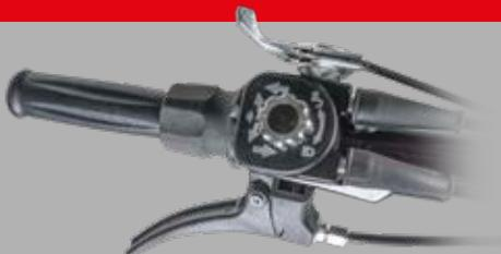
Tableau de bord clair avec compteur d'heures de fonctionnement et réglage de la hauteur du guidon
