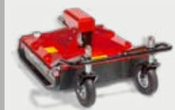
**Réglage exact des hauteurs** (10 mm min.) grâce à des patins porte-meule et roues de guidage → pour herbe haute jusqu'aux pelouses
