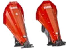
Entraînement à levier oscillant avec palier bain d'huile ou avec débrayage de sécurité. Bride anti-vibrations en option
