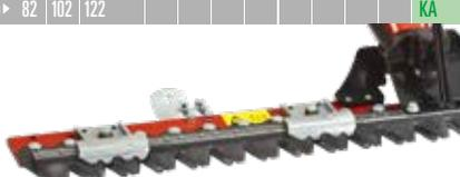
Barre de coupe universelle avec lame de coupe vissée et dos de lame de 8 mm. Faible besoin d'entretien grâce aux plateaux de poussée auto-ajustables et talons de sep. Lames doubles Köppel Korodur® 3,6 mm → longue tenue de coupe → pour situations extrêmes
