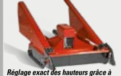
**Réglage exact des hauteurs** grâce à des patins spécial sapins de Noël et des panneaux latéraux → les branches sont guidées au-dessus des roues
