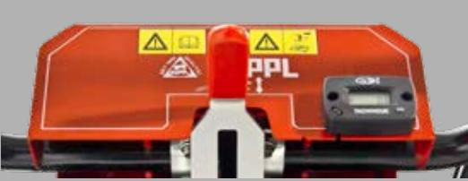
Tableau de bord clair avec compteur d'heures de fonctionnement et réglage de la hauteur du guidon
