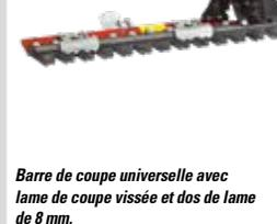
Barre de coupe universelle avec lame de coupe vissée et dos de lame de 8 mm.
