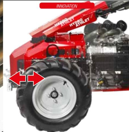
Déplacement hydraulique du centre de gravité de l'appareil. La répartition optimale du poids de l'appareil peut être déplacée progressivement jusqu'à 120 mm en fonction du cas d'application particulier.
