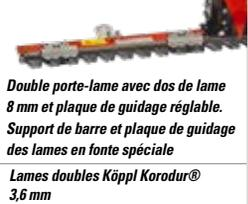
Double porte-lame avec dos de lame 8 mm et plaque de guidage réglable. Support de barre et plaque de guidage des lames en fonte spéciale
