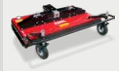
Réglage exact des hauteurs (10 mm min.) grâce à des patins porte-meule et roues de guidage
