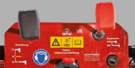
Tableau de bord clair avec réglage de la hauteur du guidon et affichage du schéma des vitesses
