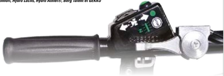
Le nouveau réglage de vitesse électronique Easy-Drive de Köppel fonctionne avec un cylindre électrique qui modifie la vitesse sur la pompe. La vitesse est commandée en avant et arrière par un interrupteur basculant sur la poignée.
