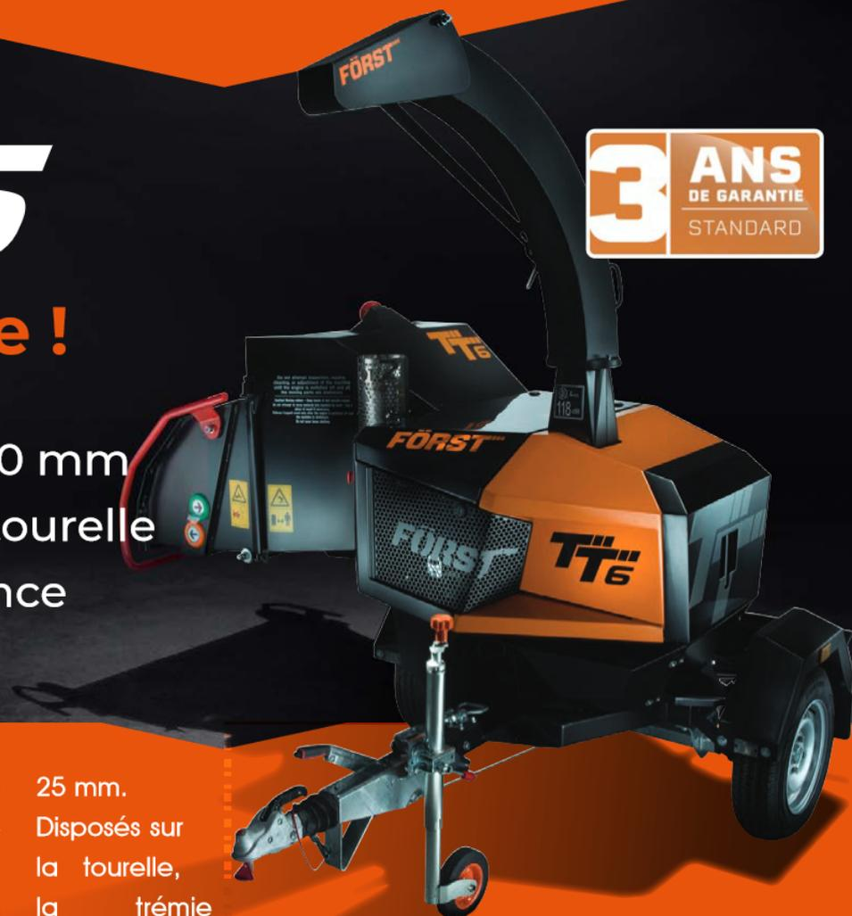
Le TT6 est un broyeur de branches sur tourelle et de moins de 750 kg. Il reprend le moteur Briggs and Stratton essence EFI de 37 cv du ST6P. Il hérite également du volant ouvert à 2 couteaux de 640 x 25 mm. Disposés sur la tourelle, la trémie d'alimentation et l'organe de coupe de s'orientent sur 360°. Le TT6 bénéficie également de la garantie 3 ans FÖRST.
