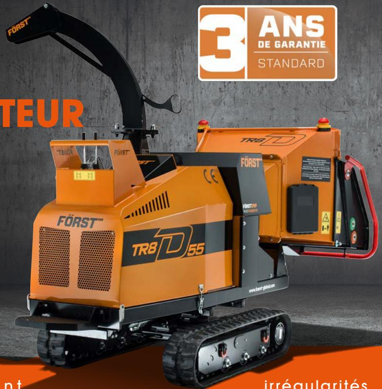
Sur chenilles, le TR8D FÖRST est un broyeur puissant et agile. Grâce à son lourd volant et son moteur diesel Doosan de 55 cv, le TR8D broie le bois sans contrainte jusqu'à 210 mm de diamètre. Il débite jusqu'à 18 m<sup>3</sup> de bois / heure. Ses chenilles
