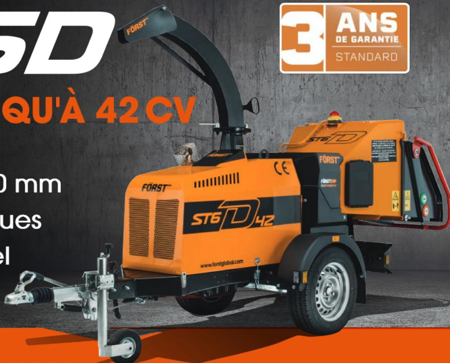
Le ST6D est un broyeur de branches de 150 mm de diamètre, montée sur châssis routier. Il dispose de 2 motorisations diesel : 24 cv Kubota ou 42 cv Doosan. Le broyeur est capable de débiter toutes sortes de branches
