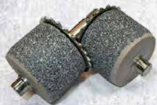
Steinwalzen geeignet für: Hafer, Dinkel, Weizen, Buchweizen usw.
