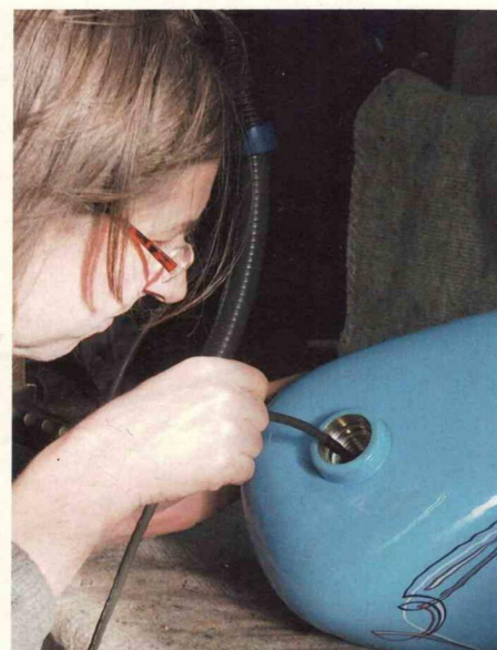
Mit einer Lampe wird der Tank nochmals ausgeleuchtet, um den Innenraum zu kontrollieren
