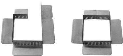
Falls der Ablauf am Rand oder im Eck sitzt, können ein Flansch oder zwei Flansche nach oben gebogen werden. Der aufgesetzte Deckel gibt dem so entstandenen Kontrollschacht Stabilität. Er wird jetzt einfach lose über den Ablauf und die ausgeschnittenen Schichten gestellt.
