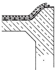
Schneiden Sie zunächst die Speicherschutzmatte so zu, dass die entsprechenden Stücke nach der Verlegung ca. 5 bis 10 cm überlappen. Achten Sie bei der anschließenden (losen) Verlegung darauf, dass die Schutzmatte
