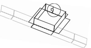
**3** Zum Schließen und Fixieren des Kontrollschachts führen Sie die ca. 3 cm hohe Lasche am Zuschnittende durch einen Schlitz und legen sie um.
