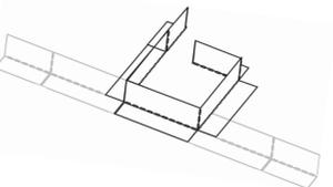
**2** Knicken Sie anschließend den Zuschnitt an den Perforationen so ein, dass sich ein Quadrat ergibt.
