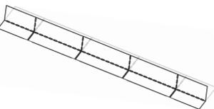
**1** Biegen Sie im 1. Schritt den Blechzuschnitt in „L“-Form so, dass der Falz oben liegt und in der Folge nach innen zeigt. Die ca. 10 cm lange Seite ergibt später den Bodenflansch.
