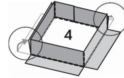
**4** Falls der Ablauf am Rand oder im Eck sitzt, werden die Enden nach oben gebogen. Der aufgesetzte Deckel gibt dem so entstandenen
