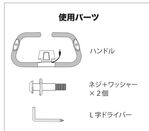
⑤ 操作パネル裏面のカバーを外し、付属の単三形電池を取り付けます。パネル裏面のネジをL字ドライバーで外します。ケーブルをパネル台の穴に通し、パネルをネジで固定します。
