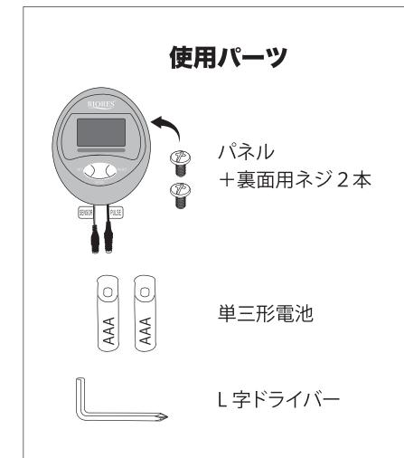
⑥ ハンドルポストからのびているケーブルとパネルの「SENSOR」ケーブルを接続します。ハンドルからのびているケーブルとパネルの「PULSE」ケーブルを接続します。それぞれ配線が違いますので、同色のケーブル同士を接続してください。
