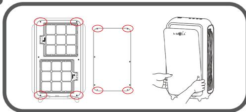
對準前面板與機身上的四個定位柱，輕輕往內推，磁石會將前面板吸附緊貼機身，前面板安裝完成。
