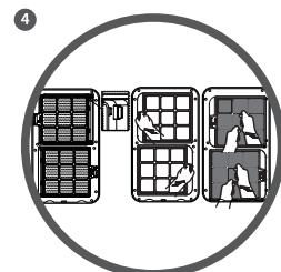
先安裝上層的寵物氧聚解反應層，再安裝組合好的高效濾網框架。聽到“啪嗒”一聲表示扣好，下層的安裝步驟同上。
