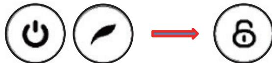
在開機狀態下，同時按下開關電源按鈕和節能模式按鈕 5 秒，機器發出提示音，童鎖圖標出現，機器進入童鎖模式。如需退出童鎖模式，再同時按下開關電源按鈕和節能模式按鈕 5 秒即可。
