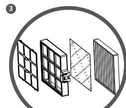
將靜電濾網放在高效濾網上方後裝入高效濾網框架中，然後把寵物初效濾網按照扣位裝入高效濾網框架上。
