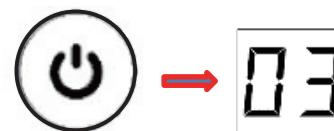
出廠設置：用戶每次切斷電源後再按開關電源按鈕開啟機器，機器設定開機風速檔位為 03 檔風量。
