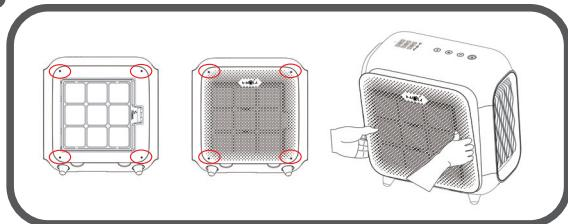
對準前面板與機身上的四個定位柱，輕輕往內推，磁石會將前面板吸附緊貼機身，前面板安裝完成。
