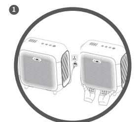
拔掉電源開關，找到前面板下方的兩個扣位，向外取出前面板。
