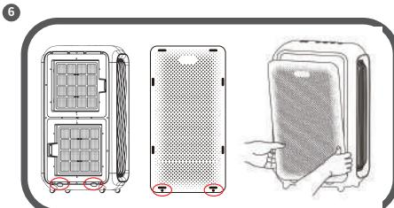
對準前面板與機身下方的兩個定位柱，輕輕往內推，磁石會將前面板吸附緊貼機身，前面板安裝完成。
