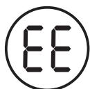
當顯示屏出現 “EE” 字樣、發出 “滴滴·滴滴” 聲且機器不運作時，即表示產品的高效濾網或氧聚解反應層安裝不正確，請重新安裝過濾組件。
