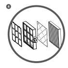
將靜電濾網放在高效濾網上方後裝入 高效濾網框架中,然後把初效濾網按 照扣位裝入高效濾網框架上。
