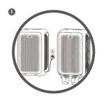
拔掉電源開關,找到前面板下方的 兩個扣位,向外取出前面板。
