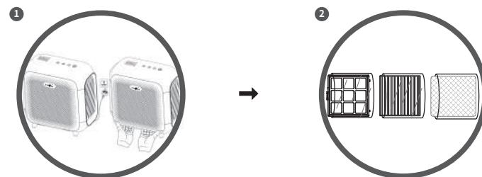
拔掉電源開關，找到前面板下方的兩個扣位，向外取出前面板。
