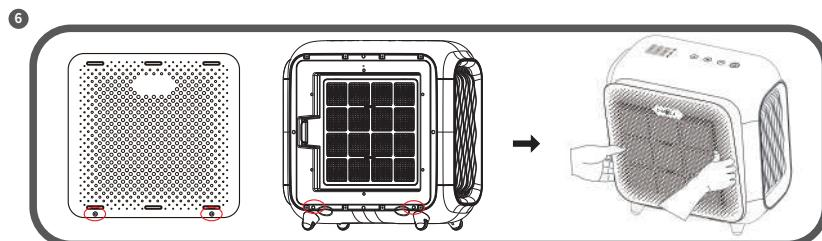
對準前面板與機身下方的兩個定位柱，輕輕往內推，磁石會將前面板吸附緊貼機身，前面板安裝完成。
