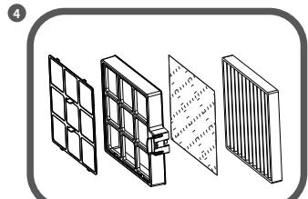
將靜電濾網放在高效濾網上方後裝入高效濾網框架中，然後把初效濾網按照扣位裝入高效濾網框架上。
