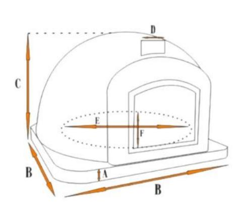
Important: Dû au fait que nous fours en brique sont fabriquer a la main, la mesure intérieur de la voute peut variée entre 1 et 2 centimètres, pour plus ou moins.
