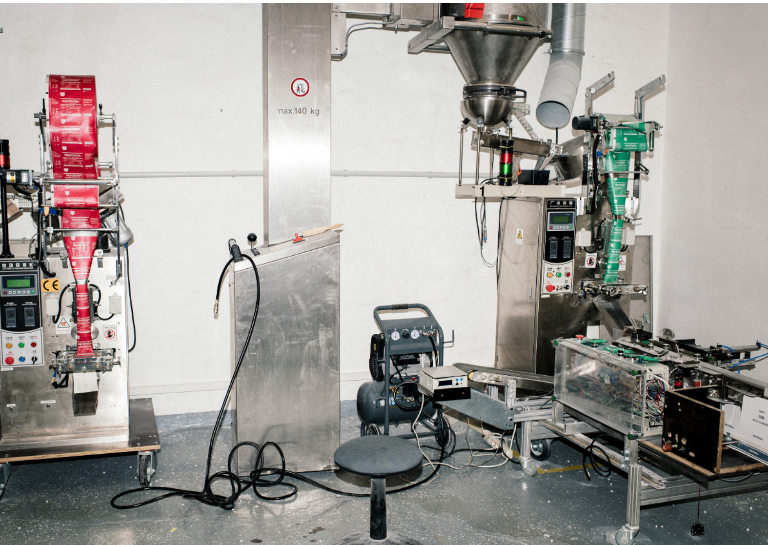
Mithilfe dieser Maschine füllt Denttabs die Zahnpfutzpillen in kleine Tütchen aus einer äußeren Papier- und einer inneren Bioplastik-Folie
