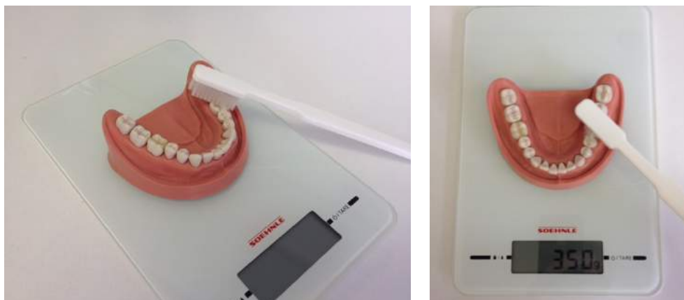
Abb. 4.1: Digitale Waage zur Kalibrierung auf eine Putzkraft von 3,43 N (350 g)
