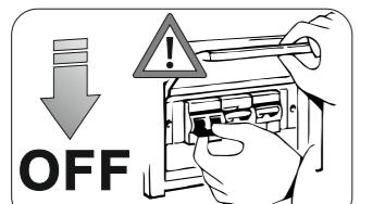
**ATTENZIONE:** Collegare l'apparecchio se la tensione di rete è attivata potrebbe danneggiare irrimediabilmente i LED.
