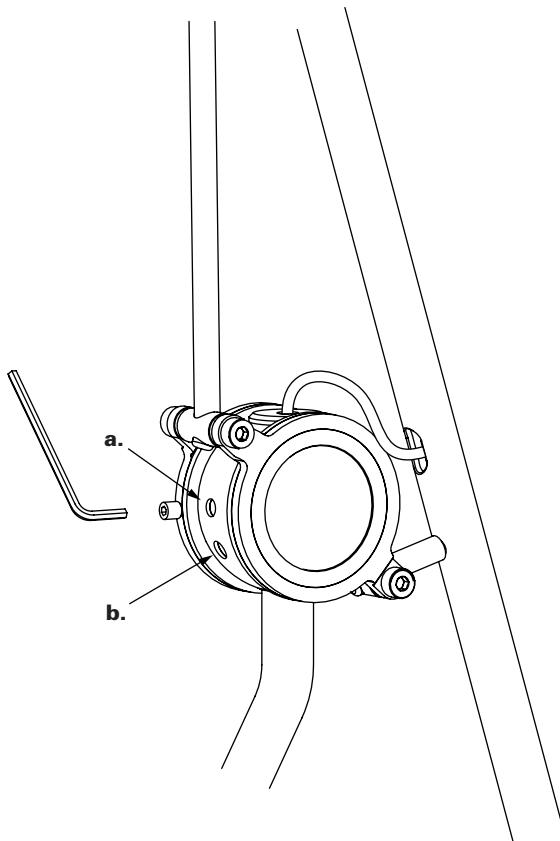
**a. Vissez la vis afin de limiter la rotation et l'enroulement du câble**
