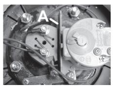
Figura 15 - Separador plástico / A : separador plástico
