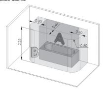
Figura 4 - Zona de instalación / A : Volumen estructura / B : Volumen de protección
