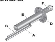
Figura 2 - Resistencia esteatita + ánodo de magnesio
