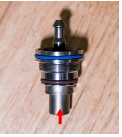
INSTALL THE PISTON HAT BACK ON TO THE UNDERSIDE OF THE SEAL HOUSING
