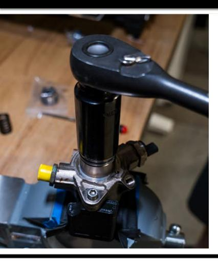
TIGHTEN FUEL PUMP NUT TO 40 FT/LBS
