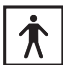
Protecção tipo BF (grau de protecção contra choque eléctrico – não existe qualquer ligação condutiva com o doente).
