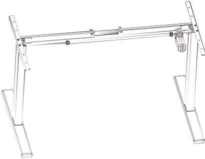
Desenrosca las tuercas de los dos extremos del eje motor, conéctala con el motor y la barra hexagonal y enrosca de nuevo para fijarla sin apretar demasiado.
